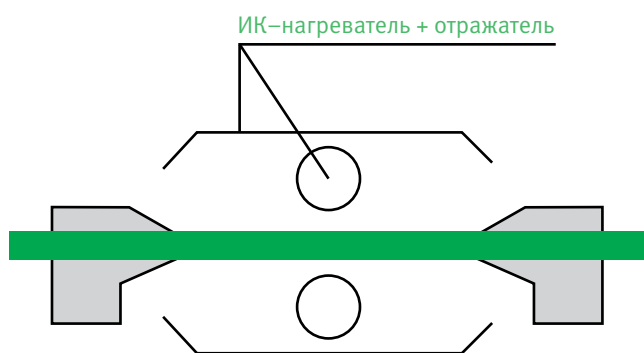
Рисунок 5. Горячий линейный изгиб. Стекло Novattro® должны местно нагреваться с помощью ИК-излучателей или провода сопротивления.
