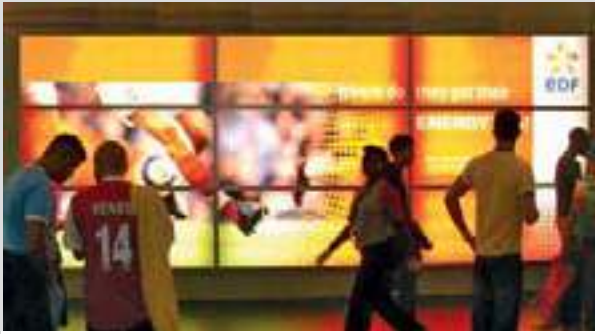
Световое рекламное табло на стадионе «Арсенал», Англия. Применялся 5 мм лист монолитного поликарбоната молочного цвета.
